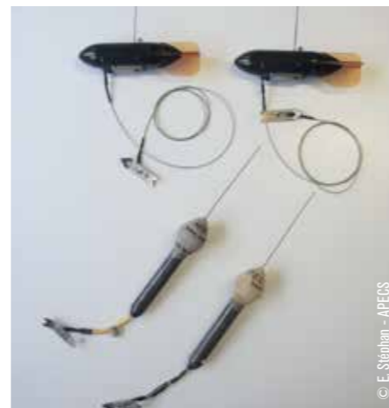
▲ Figura 1: Balizas con las que se pueden marcar los tiburones peregrinos por Wildlife Computers. Los marcadores de rastreo de animales MK-10 PAT (abajo) almacenan datos durante un periodo de varios meses antes de desprenderse del animal para subir a la superficie y transmitir los datos. Las balizas SPOT remolcadas (arriba) emiten cuando el tiburón está en la superficie.
